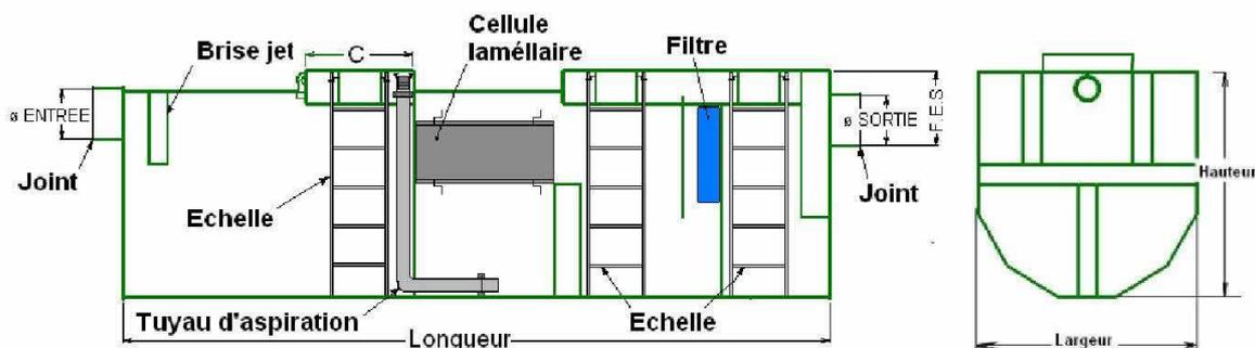
Le **DLF** est équipé de manchettes d'entrée et sortie avec joints intégrés, d'un brise jet d'entrée, d'une grille, d'une cellule lamellaire, d'un tuyau d'aspiration des boues sous cellule, de deux cloisons siphonides, d'une cartouche de filtration ou une cartouche avec média oléophile démontable, de deux amorces de puits de visites avec ouverture libre équipées d'échelles et d'une trappe d'accès.
